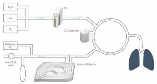
Wenn keine Rückatmung erwünscht ist, empfehlen wir dem Benutzer, den Frischgasfluss höher als das ausgeatmete Minutenvolumen des Patienten einzustellen. Wenn der Benutzer den Frischgasfluss auf 20 I/min einstellt, ist das System so ausgelegt, dass es den Frischgasfluss automatisch auf knapp über dem Minutenvolumen des Patienten einstellt und somit ein nicht rückatmendes System garantiert.
