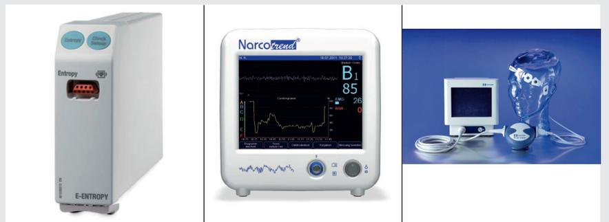
Darstellung dreier unterschiedlicher EEG-Geräte zur Messung der Narkosetiefe: Entropy-Modul der Firma GE Healthcare (links); Narcotrend® Compact M der Firma MonitorTechnik (Mitte); BIS Vista-Monitor der Firma Covidien (rechts).
